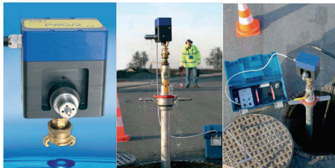
PWG/2 Busca de tubagens enterradas com emissão de ondas pulsadas
