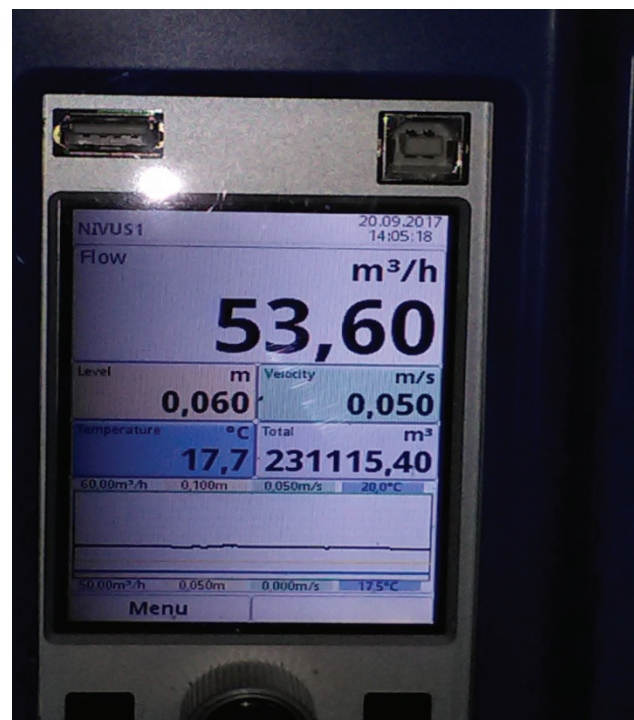
Exemplo do display do caudalímetro montado na ribeira de Aldoar
